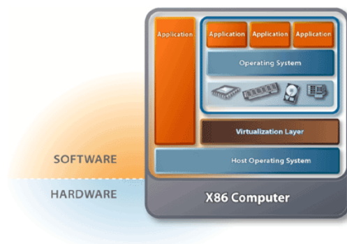
Figura 2.3: Struttura di VMware Workstation
